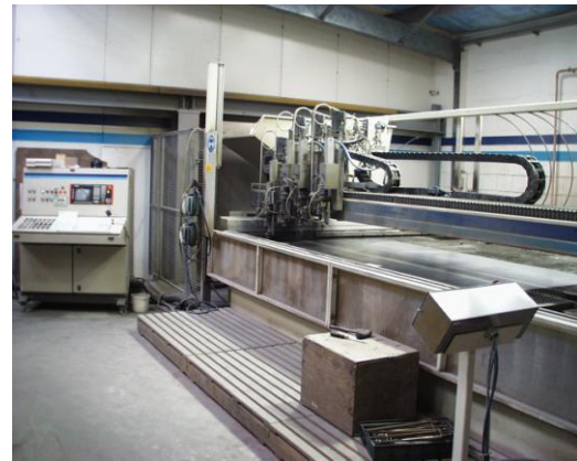
Abb. 19 Vierkopf- Schneidetisch bei KMT Waterjet Systems, Bad Nauheim
