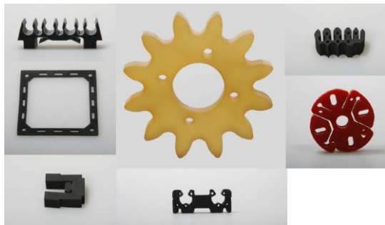
Abb. 8 Purwasserschnitte die bei KMT Waterjet Systems durchgeführt wurden
