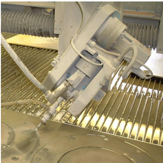
Abb. 21 5-Achsen- 3-D Schneidanlage mit KMT-Schneidkopf
