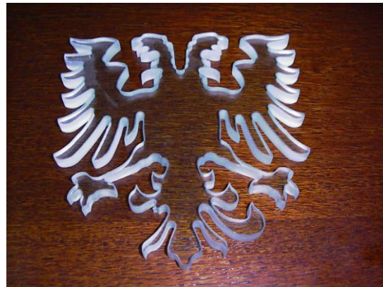
Abb. 17 Doppeladler aus 20 mm Glas geschnitten
