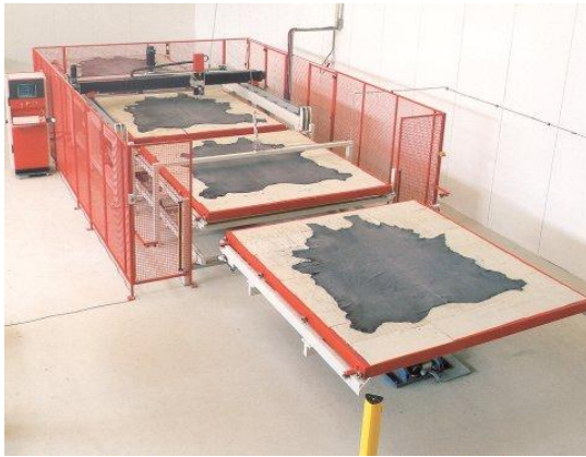
Abb. 10 Lederschneidanlage mit optischer Erkennung und Nesting
