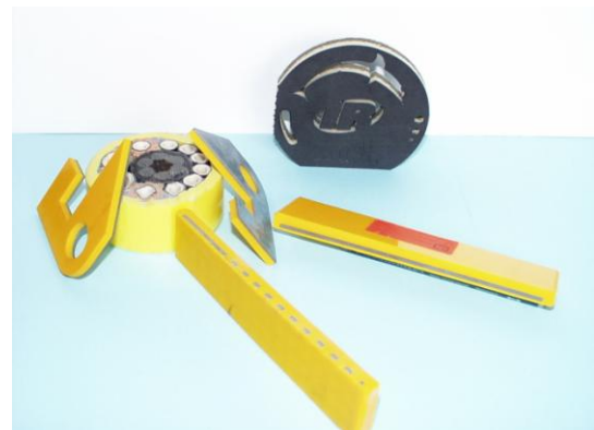
Abb. 26 Hochseekabel, Kunststoff mit Metall-einlage und Velours/Schaumstoff/Glasfaser-Textil
