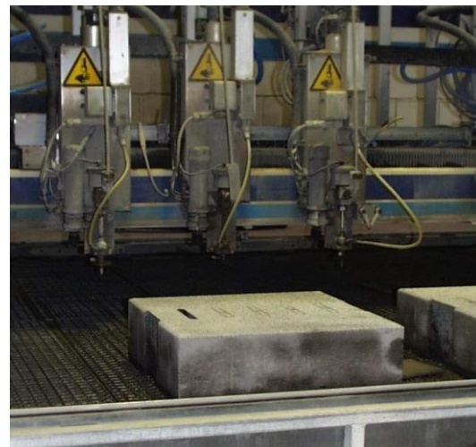
Abb. 14 180 mm starke Betonplatten werden bei KMT Waterjet bearbeitet
