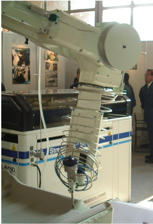
Abb. 20 Roboterarm mit KMT-Schneidkopf für Automobilzulieferer
